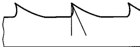
Рисунок 9 — Форма с пропуском зуба и положительным передним углом
